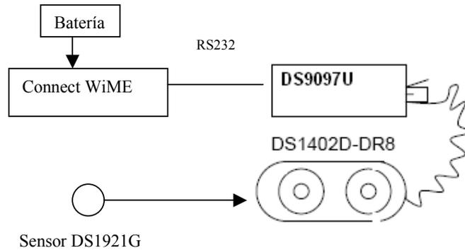
En cuanto al adaptador DS9097U, su función es la de resolver la complejidad del protocolo 1-Wire de Dallas para la lectura de sus iButtons traduciendo la comunicación establecida en el bus de datos 1-Wire al protocolo RS232 y viceversa.
