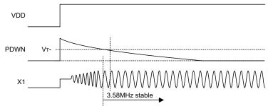
Note: reference  $C_1=0.1\mu F R_1=81k\Omega$
